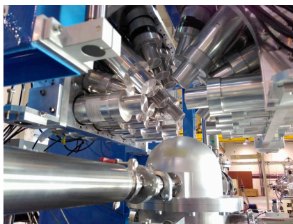
Figure 1 : Expérience STELLA auprès de l'accélérateur Andromède (Orsay). Haut : Détecteurs \text{LaBr}_3 . Bas : Chambre à réaction.
