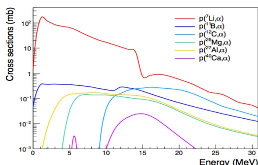
Figure 1 : Sections efficaces de quelques réactions de protons avec différentes cibles permettant la production de particules alpha..
