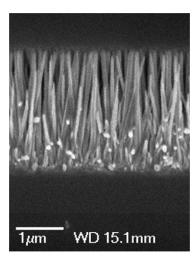
Figure 1 : Nanobâtonnets d'oxyde de zinc
